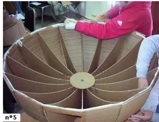
Una vez cubierto el manto radial, se procede a cubrir el manto parabólico, que posteriormente se cubre con un material vinílico reflectante. **nº6**
